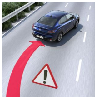
АКТИВНА СИСТЕМА ЗА ПРЕДУПРЕЖДЕНИЕ ПРИ НЕВОЛНО НАПУСКАНЕ НА ПЪТНАТА ЛЕНТА
